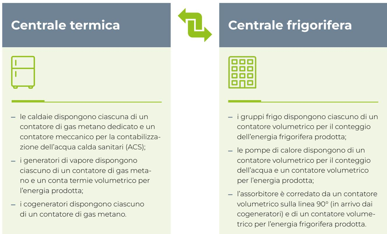
Tutti i contatori sono collegati, con *protocollo Bacnet*<sup>31</sup>, al sistema di supervisione BMS<sup>32</sup>, al sistema di supervisione BMS al quale è connessa la centrale operativa che provvede ad analizzare i dati e genera grafici sulla base dei quali vengono costantemente aggiornati i settaggi delle macchine al fine di ottenere il maggior rendimento delle stesse, efficientando al massimo i consumi di energia.
