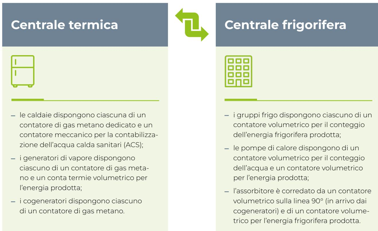
Tutti i contatori sono collegati, con *protocollo Bacnet*<sup>28</sup>, al sistema di supervisione BMS<sup>29</sup> al quale è connessa la centrale operativa che provvede ad analizzare i dati e genera grafici sulla base dei quali vengono costantemente aggiornati i settaggi delle macchine al fine di ottenere il maggior rendimento delle stesse, efficientando al massimo i consumi di energia.
